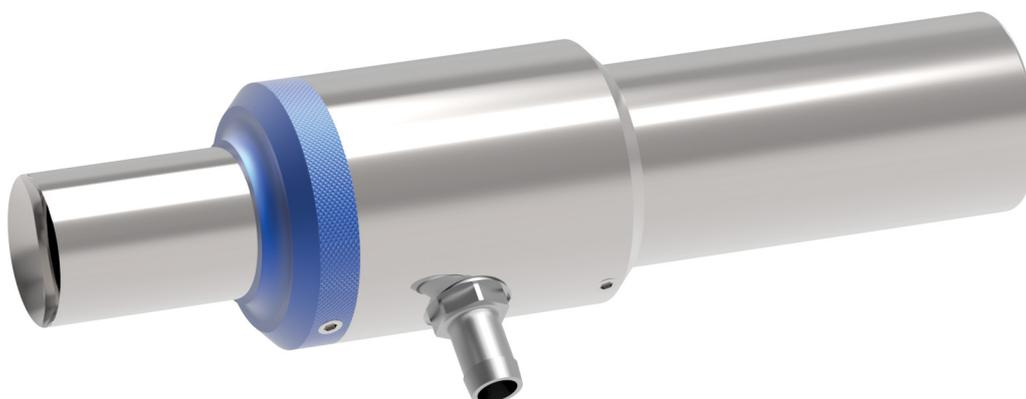
Si tratta di un eiettore normalmente impiegato quando è richiesta elevata portata con basso livello di vuoto. Il consumo di aria e la portata è regolabile. Possono essere convogliate piccole quantità di materiale. Questa pompa è disponibile in acciaio inossidabile o in alluminio. Quando viene montato un inserto, l'eiettore cambia caratteristiche fornendo alto vuoto e una bassa portata. Viene fornito con un raccordo 3/8" per tubo flessibile per il collegamento dell'aria compressa.
