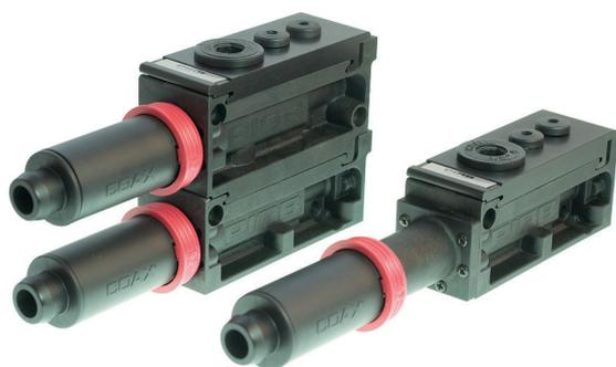
È una pompa pneumatica multistadio compatta ed impilabile, basata sulla tecnologia COAX®. È equipaggiata di controlli integrati e funzioni speciali, come la valvola on/off, valvola per il controsoffio, vacuostato, energy saving, ecc... È una piattaforma configurabile, rendendo facile la selezione dell'esatta funzione richiesta dal sistema.
