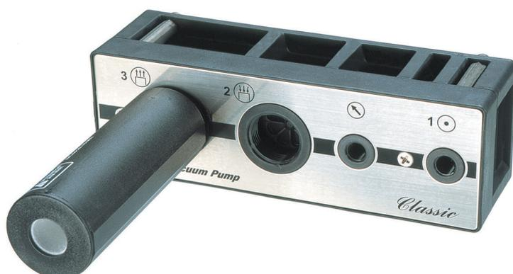
Una pompa a vuoto tradizionale Piab sviluppata per essere utilizzata nell'industria chimica o in ambienti chimicamente aggressivi. Si possono raggiungere livelli di vuoto più elevati, anche fino al 100.8 -kPa. È disponibile con piastra di connessione in PPS (D) o in alluminio (AD). Si raccomanda di utilizzare questa pompa in applicazioni senza trafile e non porose.
